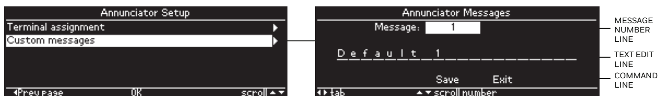
Fig. 52. Annunciator custom messages setup
